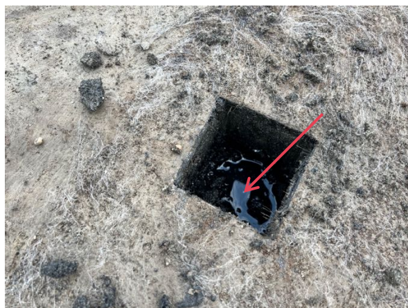
stehendes Wasser, ca. 10 mm
